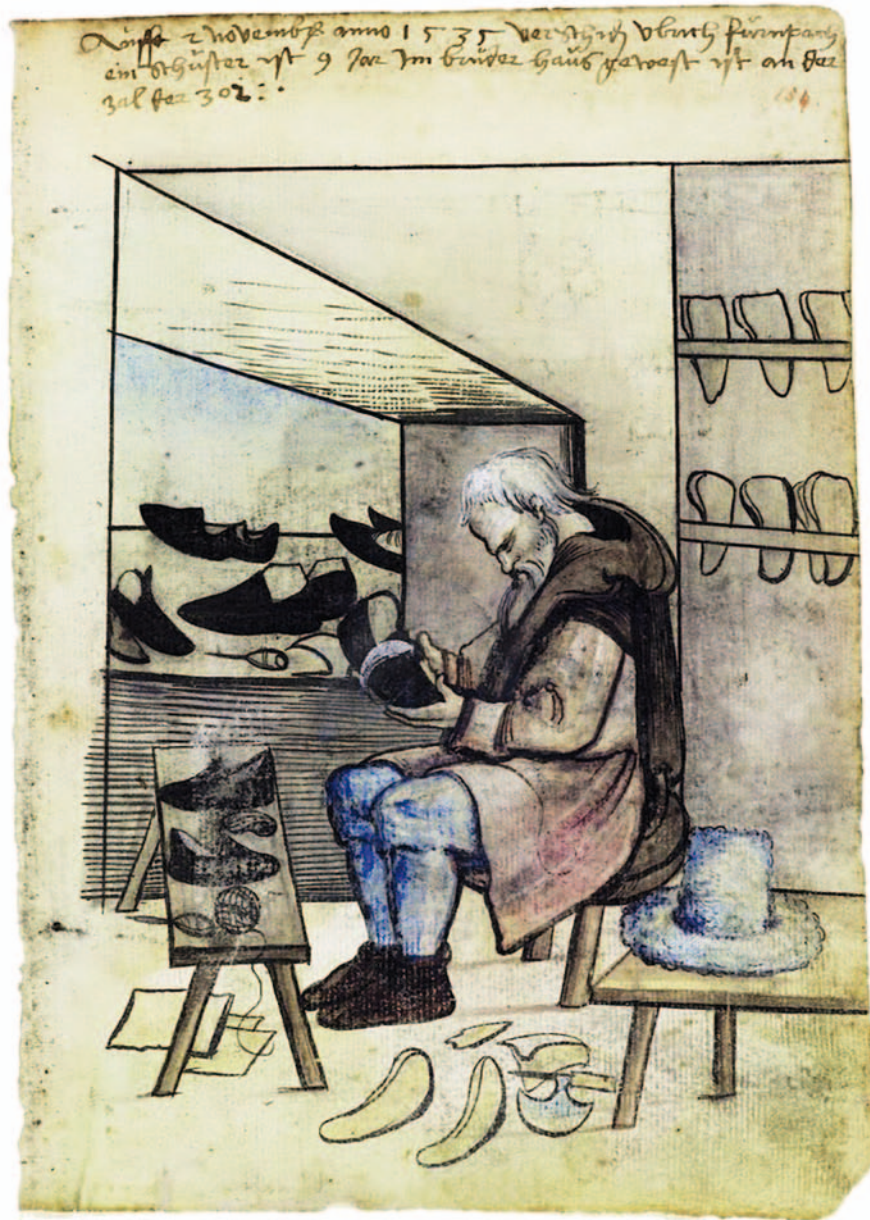
Kresba zachycuje ševce Ulricha Fürnpacha při výrobě obuvi, jak sedí na ševcovské stoličce a nejspíše upravuje botu vnějším strubadlem ve své dílně. Na vyobrazení vidíme běžné obuvnické nářadí a pomůcky: řezací nůž na kůži ve tvaru půlměsíce, sídla, přívzi a v nástěnném držáku ševcovská kopyta (Stadtbibliothek Nürnberg, Hausbuch der Mendelschen Zwölfbrüderstiftung, Band 1, 1535, Amb. 317.2 o , fol. 154r, dostupné z: https://hausbuecher.nuernberg.de/75-Amb-2-317-154-r/data )
